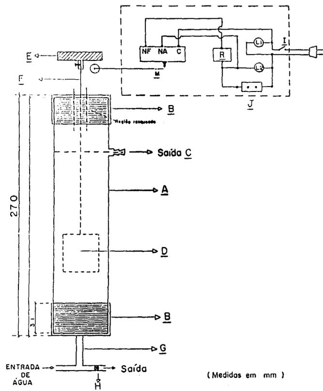
Quando o nível d'água no tubo A sobe, a bóia (D) de plástico flutua ligando o microswitch (M), que por sua vez ativa o mini-relé (R)<sup>6</sup>, energizando a tomada (J) e acendendo a lâmpada de advertência (L2). Com a interrupção
